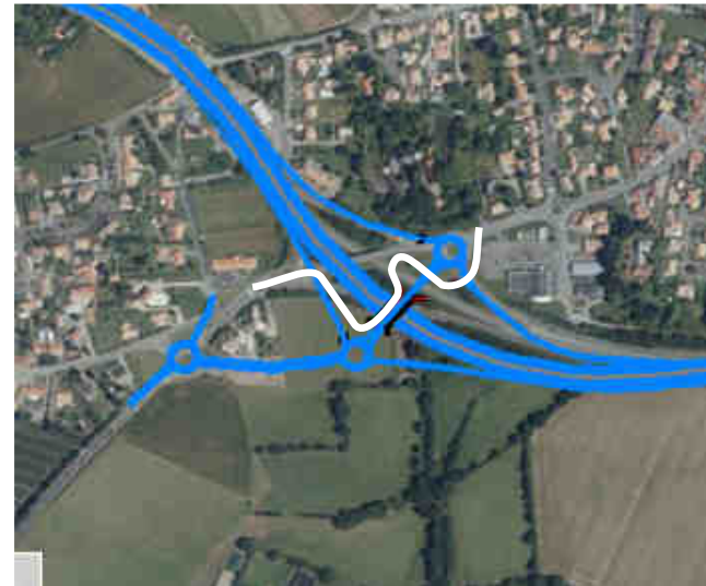
Suppression d'une boucle de la liaison douce en longeant la 2x2 voies et en passant au-dessus de la bretelle de sortie depuis Pornic
