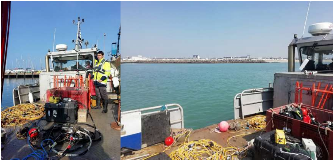
Figure 3: Photos du matériel d'acquisition en mer (flûte sismique et canon à air)
