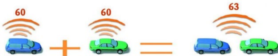
Représentation de l'addition de deux sources de bruit de même intensité
